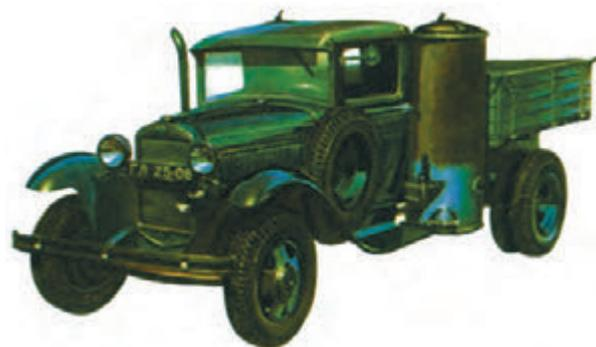
*ГАЗ-42. Топливом служил газ — продукт перегонки древесных чурок в смонтированном на автомобиле газогенераторе*
